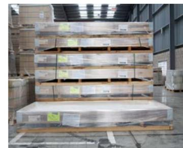
Apilamos un máximo de 6 alturas, lo que equivale a 12 cajones por contenedor que equivale a una superficie de 898.56m<sup>2</sup> de lámina cerámica con un peso neto de 12.580 kg
