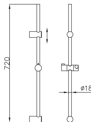
**SB30281****Barra deslizante Ø18 x 720mm. con conjunto de ducha 3F**
