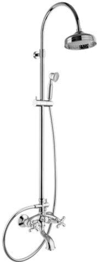
WLS7010-CR Colonna in ottone telescopica, braccio orientabile, centrale con supporto doccia scorrevole e deviatore. Soffione in ottone Ø200mm con anticalcare. Doccetta classica in ottone. Flessibile in PVC da 150 cm. Gruppo vasca in ottone cromato Brass telescopic shower column, revolving shower arm, sliding shower holder and diverter. Ø200mm brass showerhead with rain jet and rub clean. Brass minimalist handshower. PVC flexible hose 150 cm Wall-mounted bath mixer
