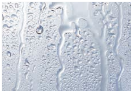
Apa care se scurge pe o sticlă netratată
